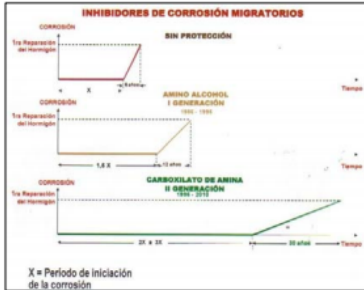
Figura 3.5: Periodo de iniciación de corrosión sin protección y con inhibidores de corrosión
